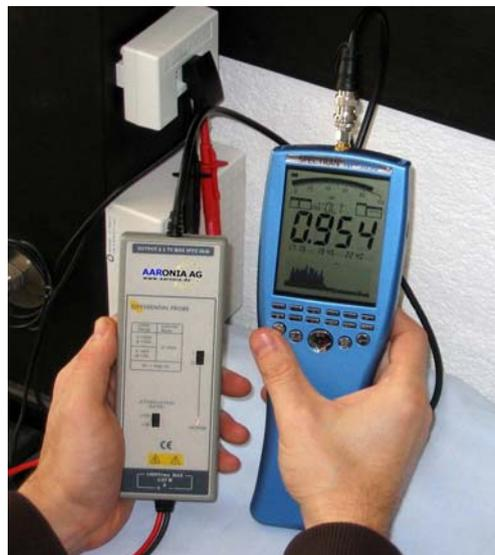
L'ADP 1, employée avec le SPECTRAN NF-5030 pour les mesures de DSL
